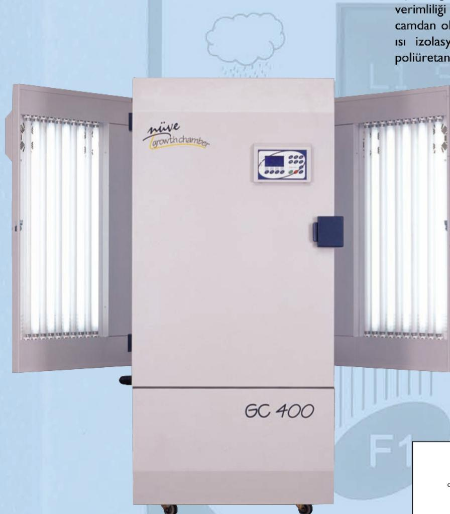
Bitki Büyüütme Kabinleri için en önemli özelliklerden bir tanesi de aydınlatmadır. GC 400'ün hücresi, sağ, sol ve üstten olmak üzere üç yüzeyden aydınlatılmaktadır. Üç yüzelyi aydınlatma sayesinde, güneş ışığının hareketi canlandırılabilir. Her üç yüzeydeki aydınlatma, 24 saatlik dilime göre ayrı ayrı programlanabilmektedir.
